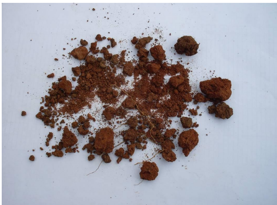
Figura 8.13 - “Peds” arestados a desarestados com mistura de faces arredondadas e planas, típicas de estrutura em blocos subangulares de diferentes tamanhos.
